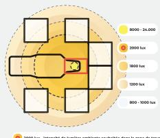
Ce diagramme illustre la distribution optimale de la lumière dans une salle de traitement dentaire, visant 1500-2000 lux autour de la cavité orale. Contactez-nous pour des calculs d'éclairage et des plans pour vos salles de traitement.
